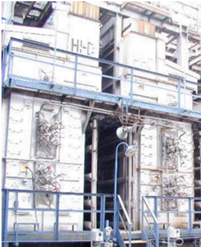
実証実験を行ったナフサ分解炉
