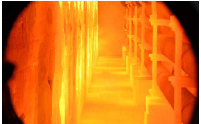
アンモニア燃焼時のナフサ分解炉内の様子
